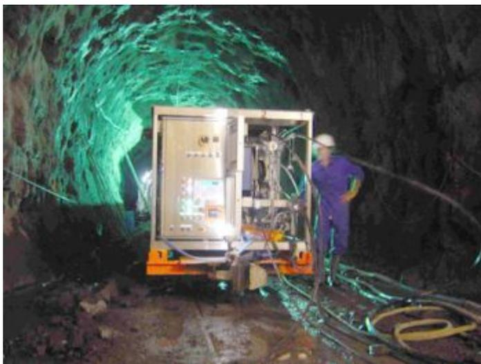
Le choix technique proposé par **EPC-Belgique** permet de produire de l'explosif uniquement à l'extrémité du flexible de pompage. Le produit fini explosif chargé dans le trou de mine est du **NITRAM TX1**. Cette émulsion est un explosif peu sensible qui nécessite un amorçage puissant (bousteur).
